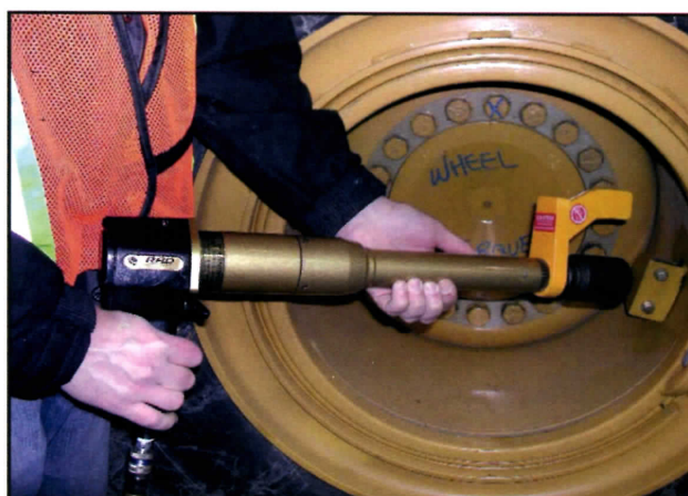
RAD 14GX (13549), 305mm 延伸鼻(14195), 加反作用力臂 (13512)
